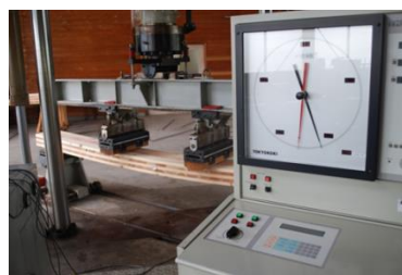
CLT曲げ強度試験状況
