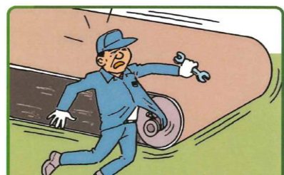
回転物の突起物には覆いを設置
